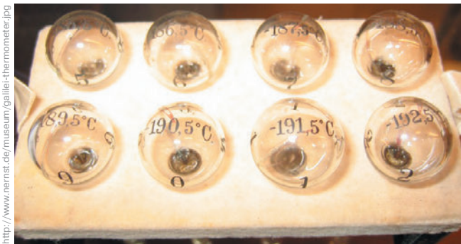
Рис. 3. Термометр Галилея для жидкого воздуха в Музее Вальтера Нернста ( University of Göttingen Physicochemical Institute ): набор из восьми стеклянных сфер диаметром 18 мм. Диапазон измеряемых температур от -192,5\text{ }^\circ\text{C} до -185,5\text{ }^\circ\text{C} с шагом 1\text{ }^\circ\text{C} .
