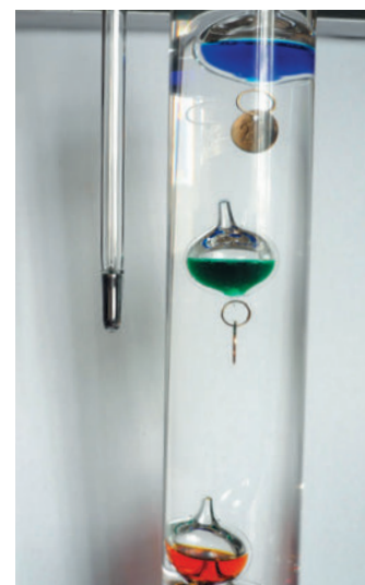
Рис. 8. После лёгкого постукивания шарик «24 °С» медленно опускается
