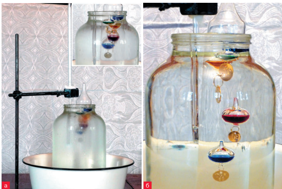
Рис. 7. Измерения температуры в водяной бане: а – температура воды 11\text{ }^{\circ}\text{C} , все шарики вверху; б – температура воды 21\text{ }^{\circ}\text{C} , шарики « 22\text{ }^{\circ}\text{C} », « 24\text{ }^{\circ}\text{C} » и « 26\text{ }^{\circ}\text{C} » – вверху, шарик « 20\text{ }^{\circ}\text{C} » начал опускаться, шарик « 18\text{ }^{\circ}\text{C} » завис посередине цилиндра
